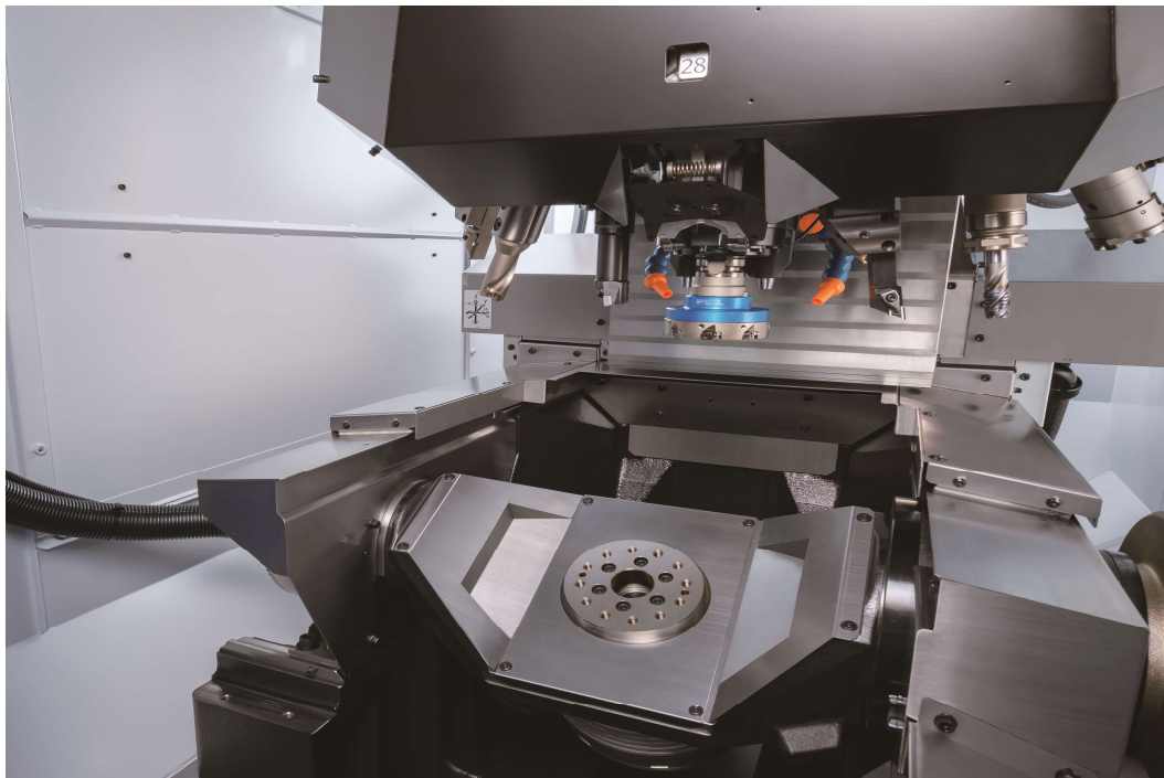
高性能 DD 馬達迴轉軸搭配傾斜軸設計.
