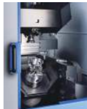
A軸-30°のときの治具・ワークへの接近性
