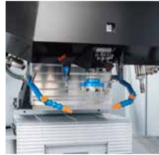
コラム部クーラントノズル 加工ワーク周辺の切粉を強制排除して堆積を防ぎます。 *40本マガジン仕様は選択できません。
