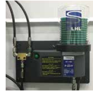
自動グリス潤滑 3軸の給脂ポイント全てに定期的にグリス給脂します。 *標準仕様は手動によるグリス給脂になります。
