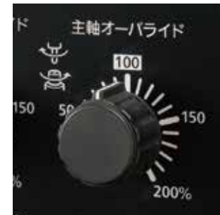
主軸オーバーライド プログラムを変更せずにスピンドル速度の変更ができます。
