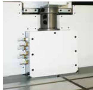
油圧ロータリージョイント4P 空圧中継ボックス12P 空圧12ポート、油圧4ポートを用意しており、空圧、油圧を使った治具の搭載が簡単にできます。 *R450Xd1では油圧ロータリージョイント使用時、Y軸移動量が少なくなります。
