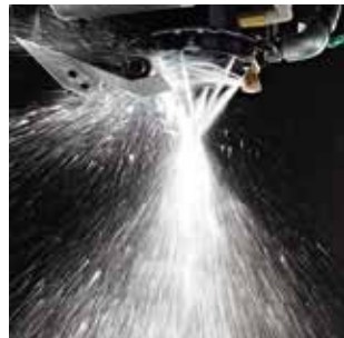
エアアシスト式ツール洗浄 高い吐出圧力・吐出流量によりホルダーに付着した切屑を強力に落とします。フィルタ目詰まりワーニング機能装備。
