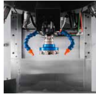
ヘッド部クーラントノズル ノズルと工具位置が一定になるので加工部位に確実にクーラントを掛けられます。
