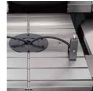
タッチ式工具折損検出 タッチスイッチ式の工具折損検出装置を用意。
