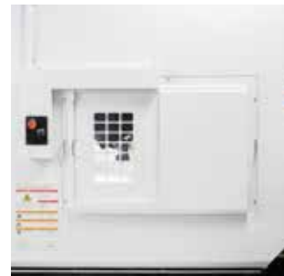
側面扉採光型 側面からの段取りや工具交換が行いやすくなります。また、採光窓により加工室の確認ができます。 *R450Xd1 22本/28本マガジン仕様、およびR650Xd1は標準装備しています。
