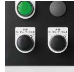
外側ロータリーテーブルスイッチ 外側ロータリーテーブルの操作が可能です。 *別途、スイッチパネル(8穴、10穴)が必要です。
