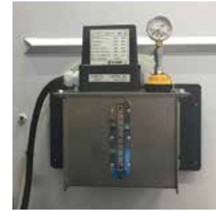
自動オイル潤滑 3軸の給油ポイントに定期的に給油します。
