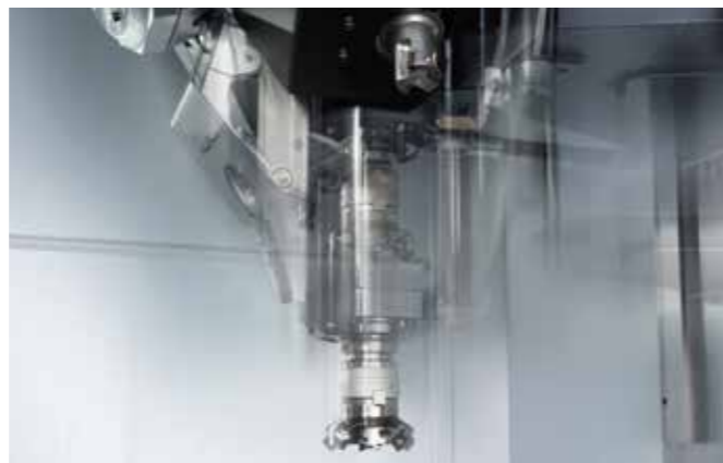
Z軸加速度 最大 2.2G Z軸早送り速度 56m/min
