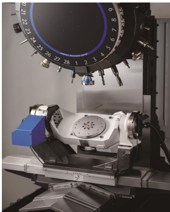
傾斜/回轉軸一體成型機身設計
