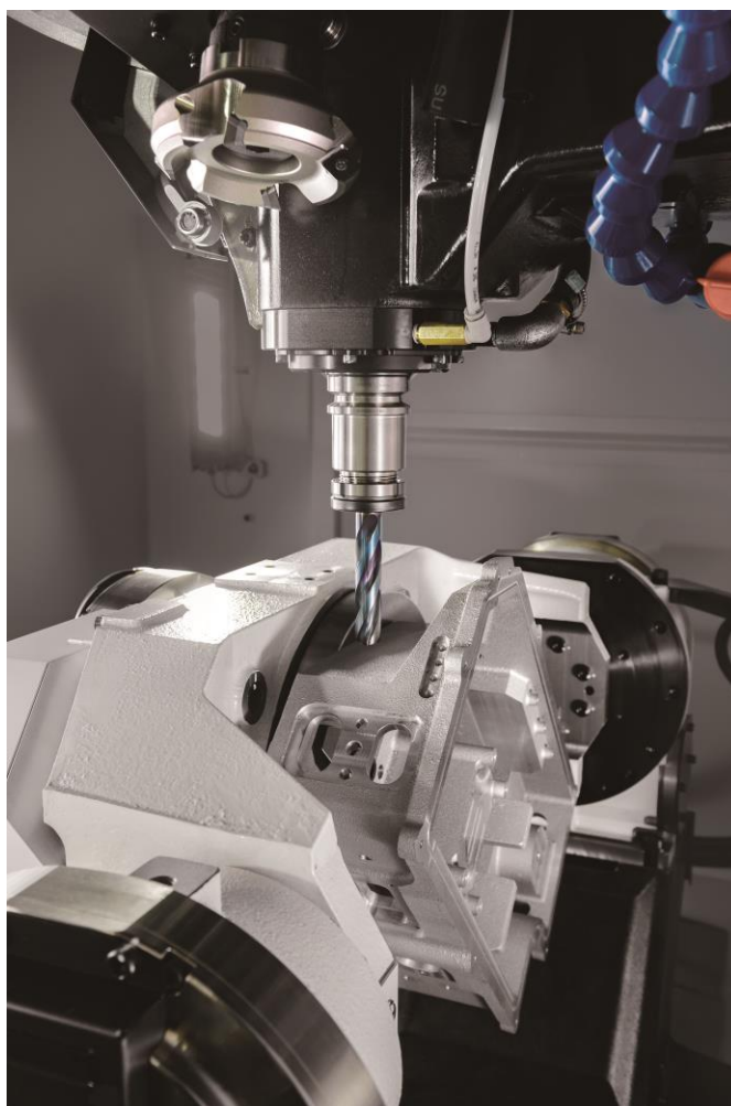
傾斜軸最大角度可達+120度-30度
